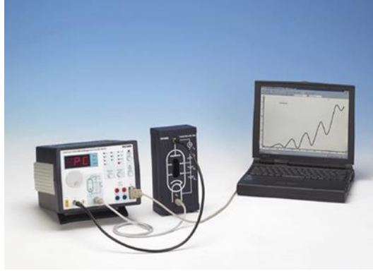
Şekil 7. Neon gazlı Franck-Hertz düzeneği
