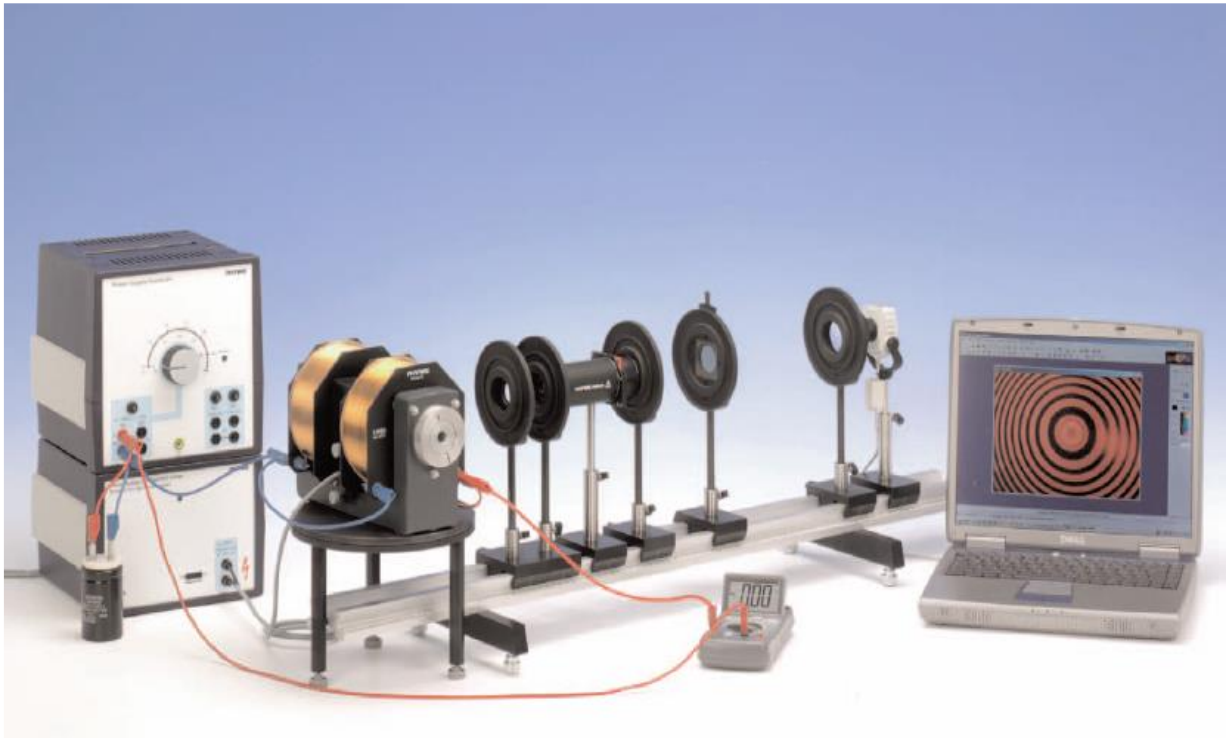
Şekil 1. Zeeman Olayı deney düzeneği
